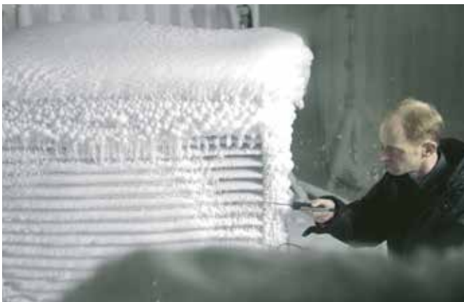
I kølerummet testes varmepumperne under ekstreme temperaturer.
